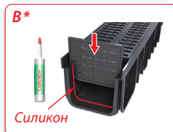
В* - Монтаж на тапа
